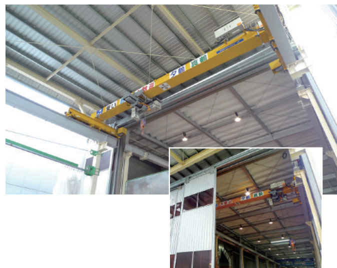
乗り移りクレーン 走行レールの中で、扉の設置も可能!
