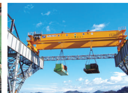
75t+75t/10t×29m 天井クレーン
